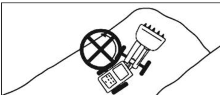
Cuando el transporte se realiza en zona de terreno inclinado, la cuchara debe estar a 20 cm. ó 30 cm. del piso. El interruptor de electricidad debe desconectarse.
