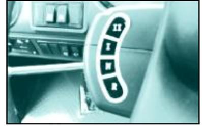
• Coloque la palanca de control en posición Neutral.
