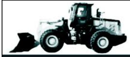
• Coloque la pala en posición horizontal sobre el piso.
