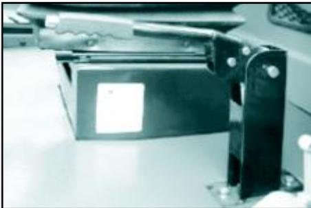
• Hale la palanca del freno de estacionamiento.
