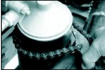
**C.3.5.4.** Colocar aceite nuevo utilizando el orificio de carga. El nivel de aceite debe estar dentro de los parámetros establecidos (gradación).
