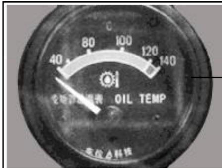
Indicador de temperatura de aceite del convertidor
