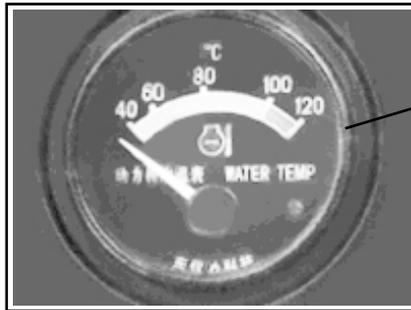
Indicador de temperatura de agua del motor
