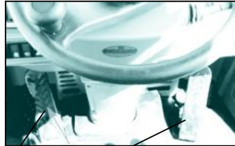
Pedal de freno    Pedal del acelerador
