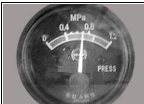
**B.3.1.7. Manómetro de Presión de Aceite de la Caja de Cambios.**
