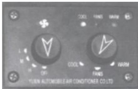
**Enfriado:** Cuando dé arranque al motor, regule los interruptores de flujo de aire correctamente. Gire el interruptor en sentido horario (la luz indicadora verde, titila). El sistema de refrigeración inicia, el aire frío sale por los orificios de ventilación.
